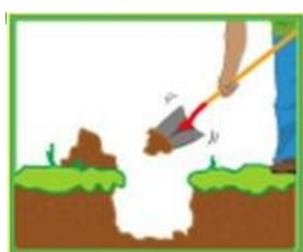
1 Cavar la tierra en una superficie de 40 por 40 centímetros de profundidad
